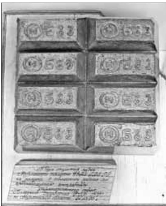
Баббит марки Б-83 (сплав из олова для ремонта подшипников судового двигателя) производства СССР. Обнаружен в 1987 году при отходе за границу рыболовного траулера колхоза «Ударник» внутри топливного танка. Всего было обнаружено 800 кг баббита.
